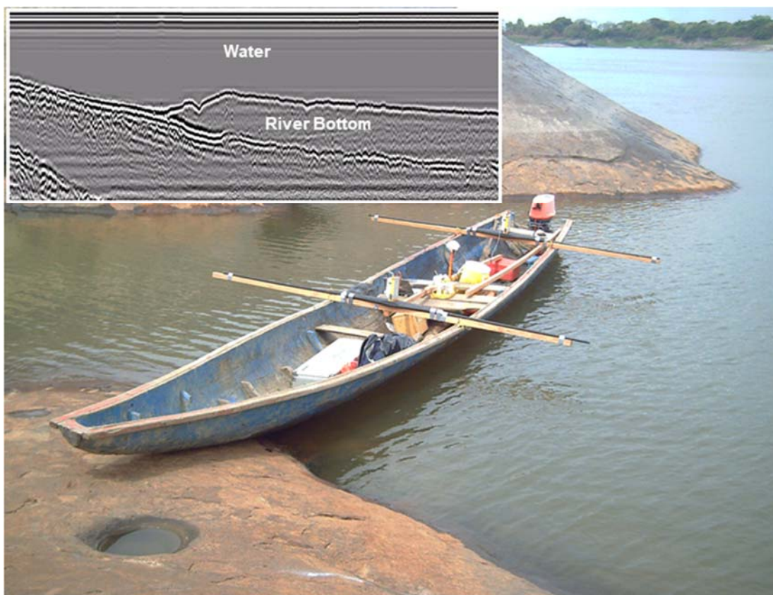
Ejemplo de adquisición y procesamiento de datos GPR en investigaciones fluviales.
