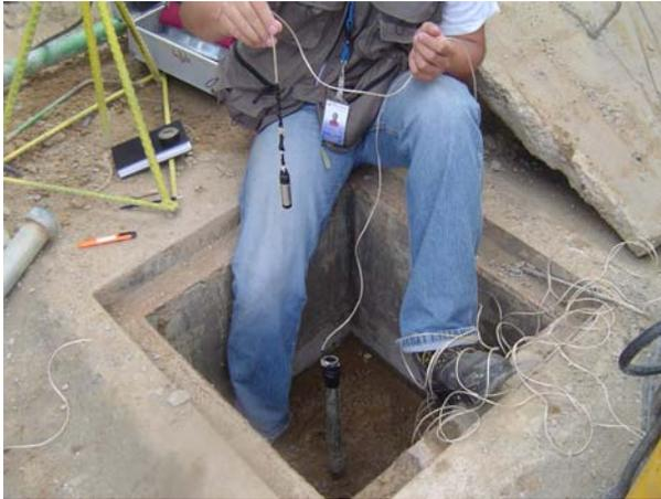
Foto 1. Instalación de MicroDiver en Piezómetro.
