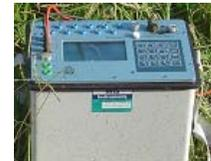
[Syscal R1 PLUS Switch-48](#) Instrumento de “switch” multicanales permite la adquisición de 48 canales en datos de tomografía eléctrica y de IP con cualquier tipo de configuración. Muy efectivo para investigación de acuíferos secundarios.
