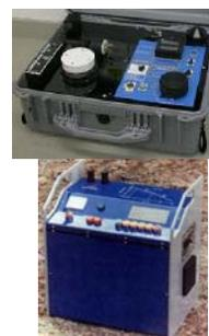
[DC-RES 500](#) (2 unidades) Instrumento de potencia intermedia (500w – 2A) alimentado por baterías. Es particularmente útil en áreas donde se necesita portabilidad y potencia para penetrar unidades superficiales como capas lateríticas y suelos residuales secos y con extensa “stone line” que limitan la inyección de corriente. Muy efectivo para la ejecución de sondeos de hasta  $AB/2 = 1500$  m.
