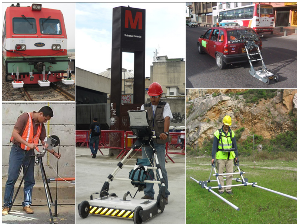
Fig. 2 Configuraciones Arreglos GPR
